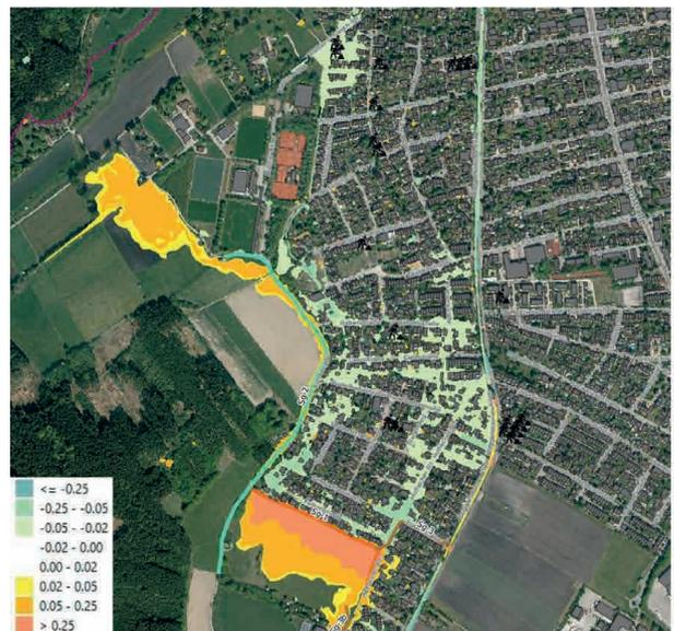
Abbildung 7-3: Wasserspiegelvergleich PLAN – IST bei BHQ West. Hinter dem Retentionsraum kann der Siedlungsbereich bis hin zum Unterlauf des Seitengraben 3 entlastet werden, insbesondere in der Hoflacher Straße und entlang des ehem. Verlaufs des Seitengraben werden die Wasserstände flächig um einige Zentimeter, teils um bis 25 cm und mehr, reduziert.
